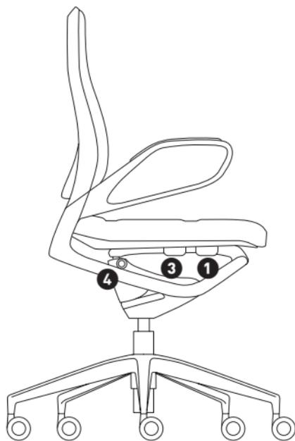
**Sitzhöhenverstellung** | *Seat height adjustment* | *Réglage en hauteur du siège* | *Zithoogteverstelling*
