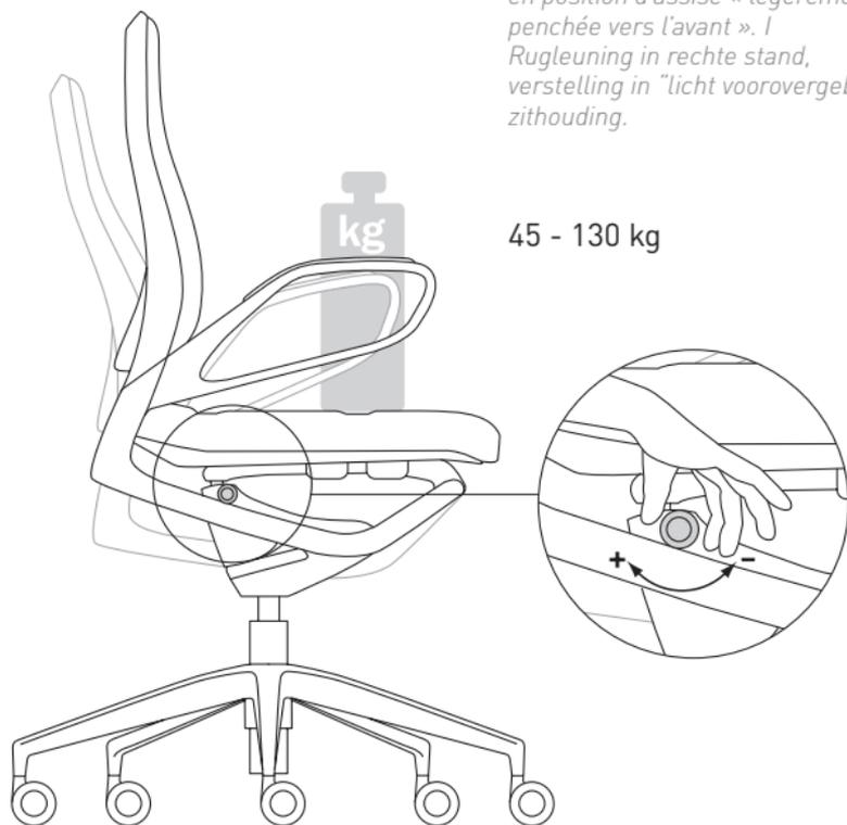
**Rückenlehne Arretierung bei 0°/Begrenzung Öffnungswinkel** | *Backrest lock at 0°/limiting the opening angle* | *Dossier, verrouillage à 0° / Limitation de l'angle d'ouverture* | *Rugleuningvergrendeling bij 0°/ openingshoek instelbaar*
